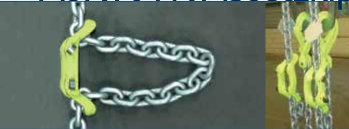
Kettenverkürzer direkt im Kettenstrang;
